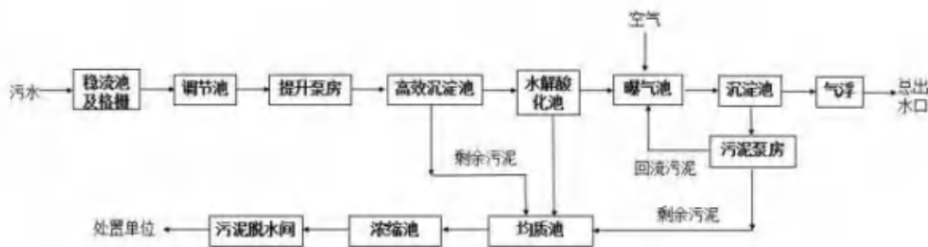
图 6.2-3 三期工程 20 万吨/天工业污水处理系统工艺流程图
